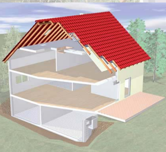
Ausgebaute Dachkonstruktion – Dachhauerneuerung mit Aufsparrendämmung und Austausch der Zwischensparrendämmung nach der Dämmmaßnahme
